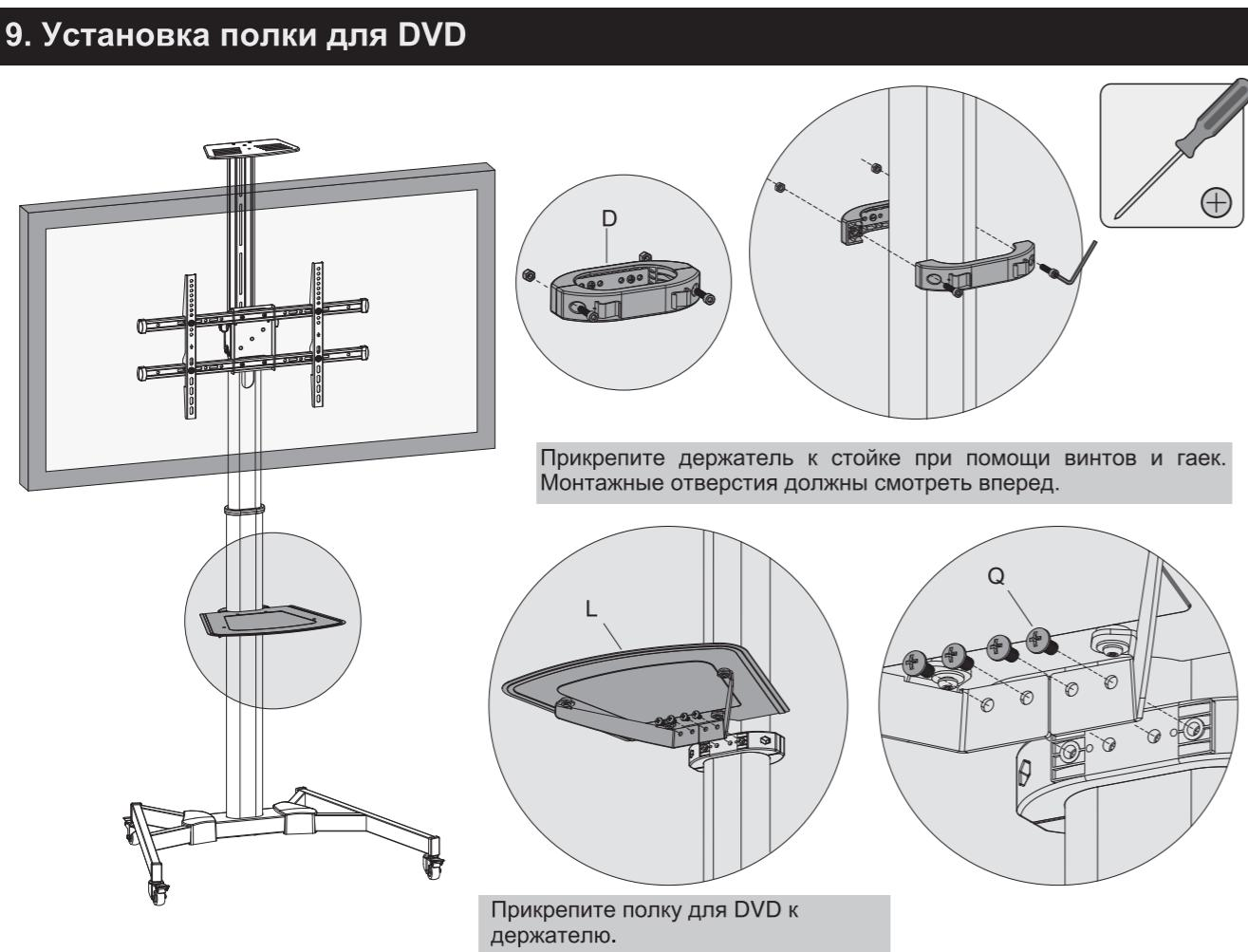
Прикрепите держатель к стойке при помощи винтов и гаек.
