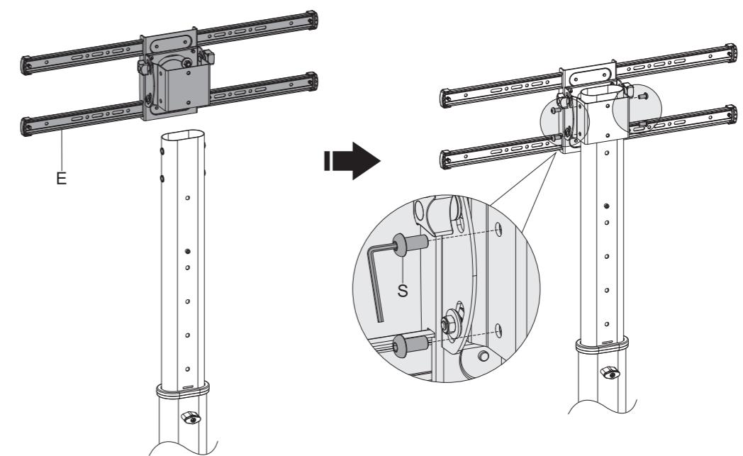
Установите универсальную пластину на стойке при помощи винтов.
