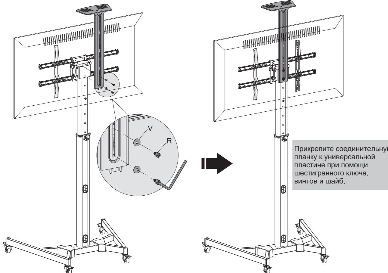
Прикрепите соединительную планку к универсальной пластине при помощи шестигранного ключа, винтов и шайб.
