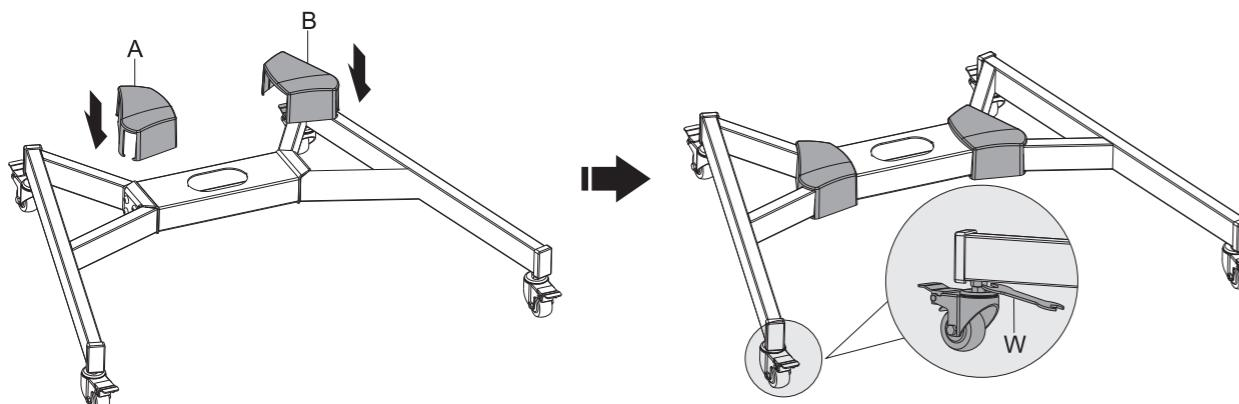
**ВНИМАНИЕ:** Во избежание случайного движения конструкции во время сборки заблокируйте ролики при помощи тормоза. Высоту каждого ролика можно настроить индивидуально. Ослабьте немного гайку для того, чтобы поднять или опустить основание.
