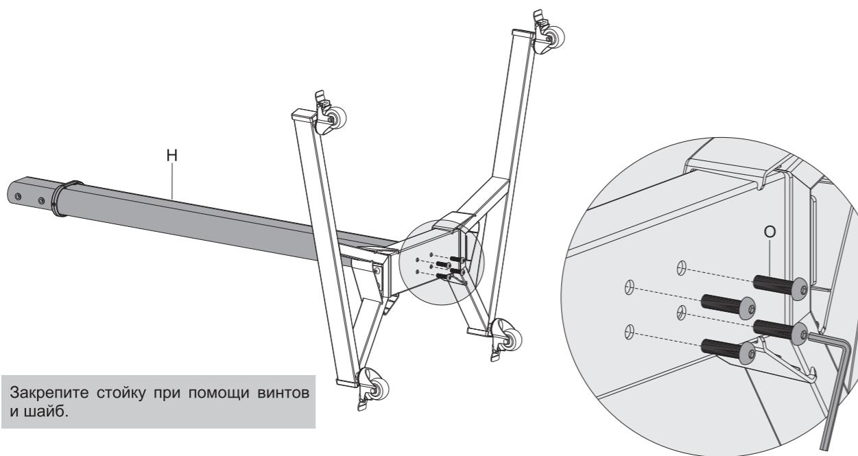
Закрепите стойку при помощи винтов и шайб.
