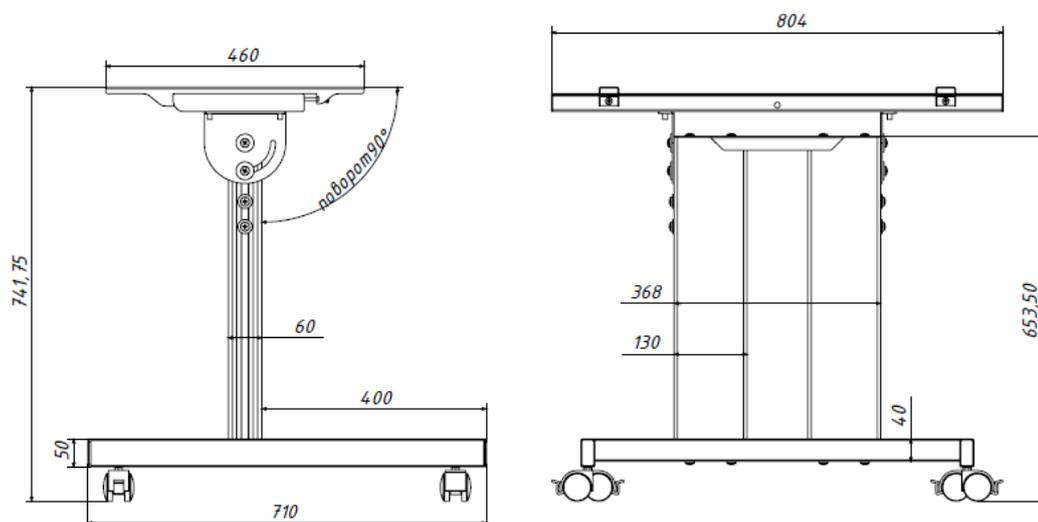
3.4. Расчетная масса всей конструкции:  $45 \pm 2\%$  кг
