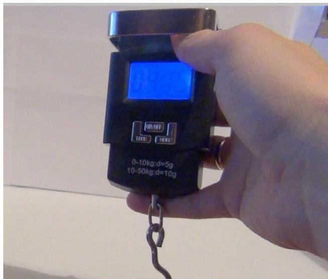
Рис.80 Значение веса, с которым сервопривод тянет весы при плече в 2 см. Примерно значение веса 0.415 кг.
