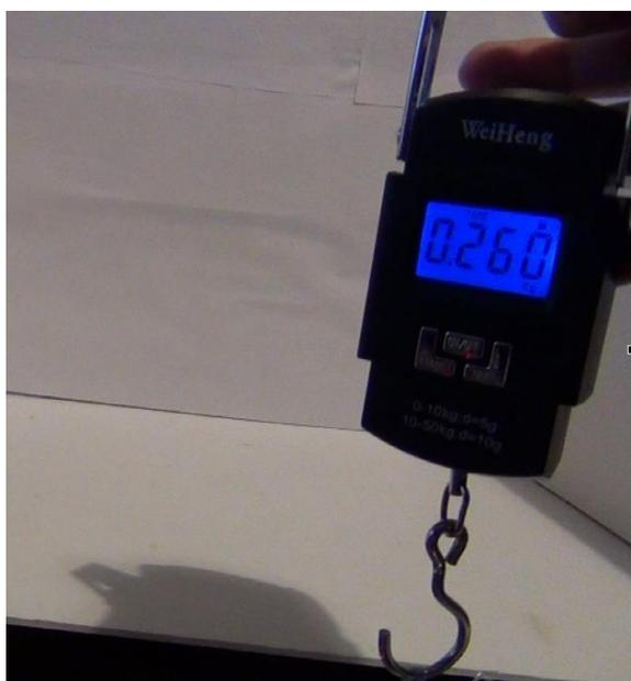
Рис.81 Значение веса, с которым сервопривод тянет весы при плече в 5 см. Вес примерно равен 0.260 кг.
