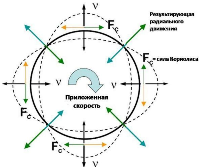
Если гироскоп подвергается воздействию угловой скорости, то на кольцо действуют силы Кориолиса: по касательной к периметру кольца относительно главных осей. Эти силы деформируют кольцо, что вызывает радиальное движение вторичных снимающих преобразователей. Данное движение, определяемое на вторичных снимающих преобразователях, пропорционально прилагаемой угловой скорости.
