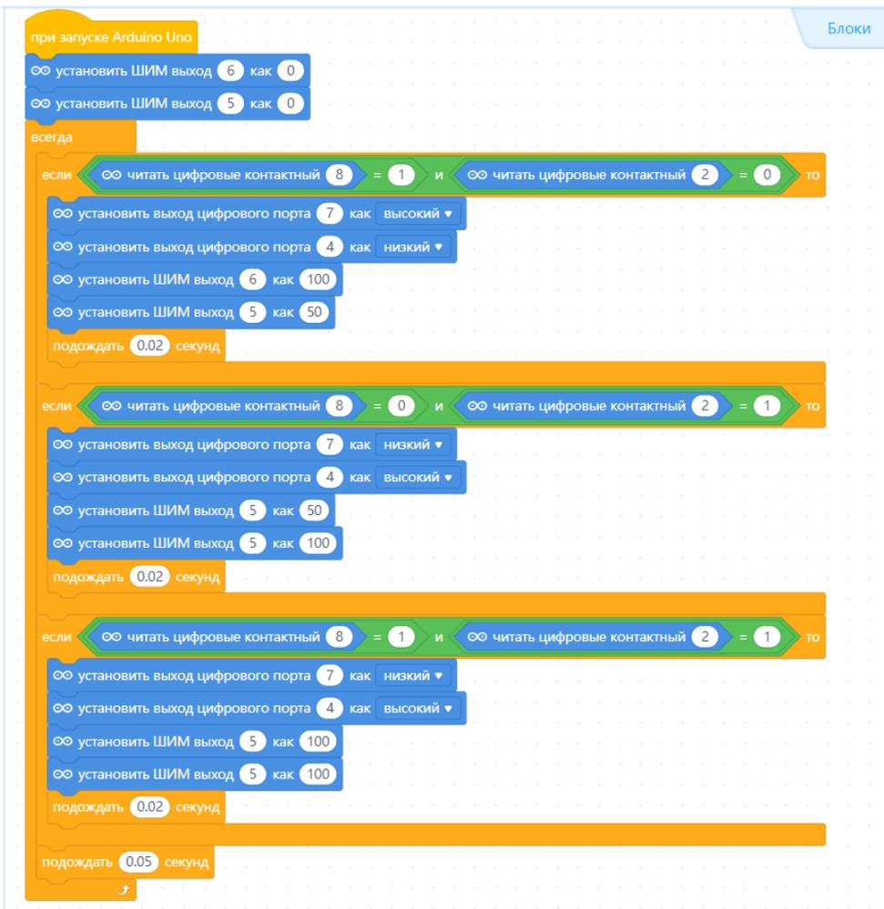
Рис.75 Программа для плавного движения по линии в MBlock5
