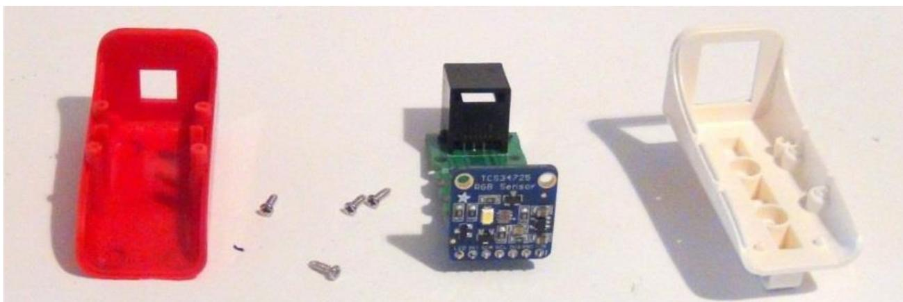
Рис.18 Датчик цвета КЛИК. Внутреннее строение
