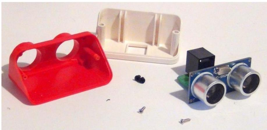
Рис.12 Ультразвуковой датчик расстояния КЛИК. Внутреннее строение
